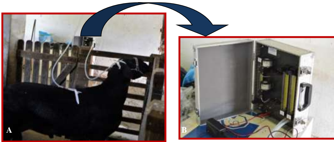
Figura 12 - Aeração dos voláteis dos animais. A - Região da aeração dos COVs; B - Equipamento de sucção dos voláteis.
