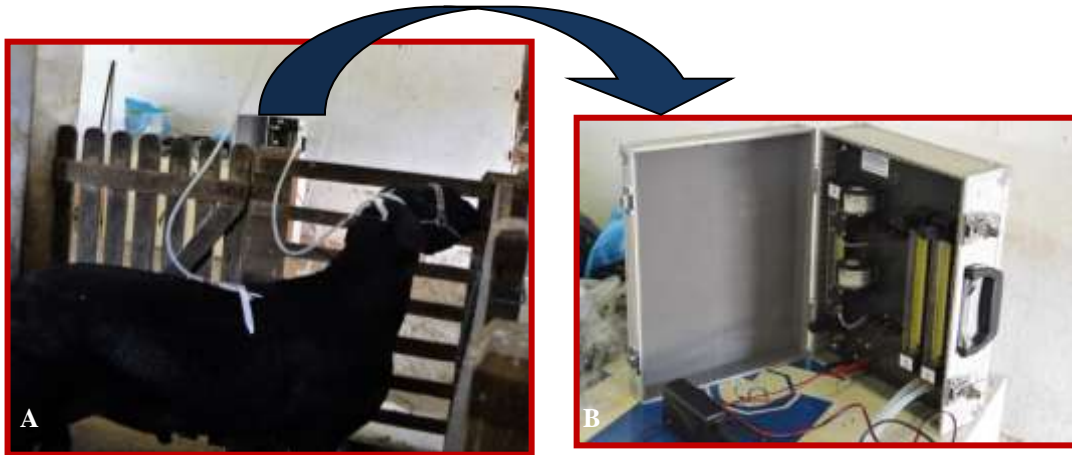
Figura 5 - Aeração dos voláteis dos animais. A - Região da aeração dos COVs; B - Equipamento de sucção dos voláteis.
